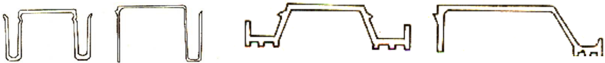
上部和侧部缓冲垫(单双排) 上部和侧部缓冲垫(单排) 下部缓冲垫(单/双排) 下部缓冲垫(仅单排)
